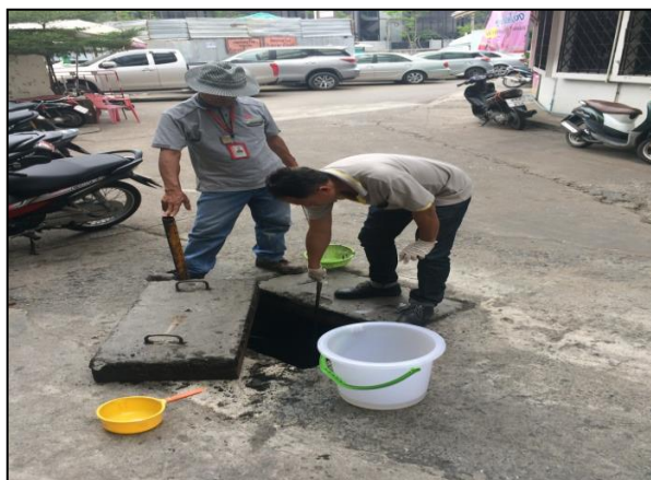
รูปที่ ๑๖ การเก็บตัวอย่างน้ำทิ้งจากบ่อพักน้ำทิ้งที่รอการสูบออกสู่ภายนอก
