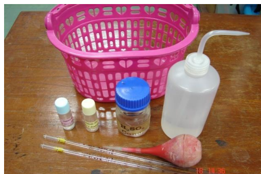
รูปที่ ๔ สารเคมีสำหรับรักษาสภาพตัวอย่างน้ำ
