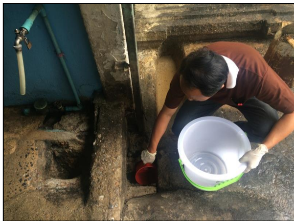
รูปที่ ๑๕ การเก็บตัวอย่างน้ำทิ้งจากรางระบายน้ำทิ้ง
